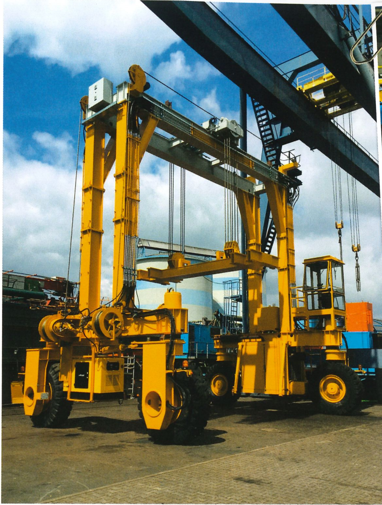
Rekordverdächtig: Für einen Kunden in Israel renovierte und modifizierte Teichmann einen Zweiträgerlaufkran – und zerschnitt diesen für den Transport.
