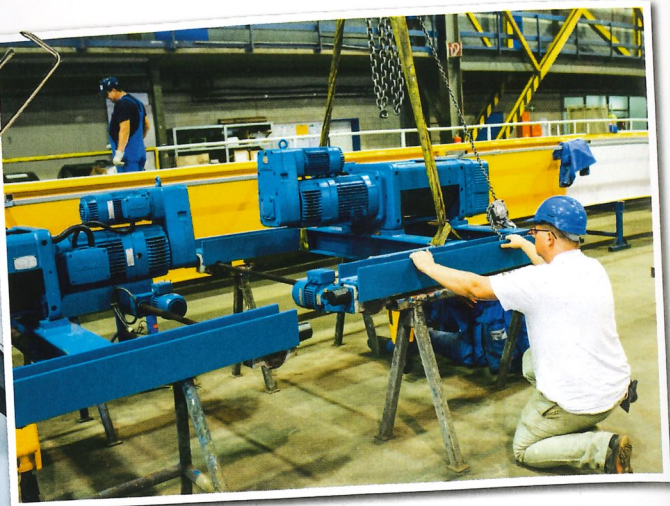
Rekordverdächtig: Für einen Kunden in Israel renovierte und modifizierte Teichmann einen Zweiträgerlaufkran – und zerschnitt diesen für den Transport.
