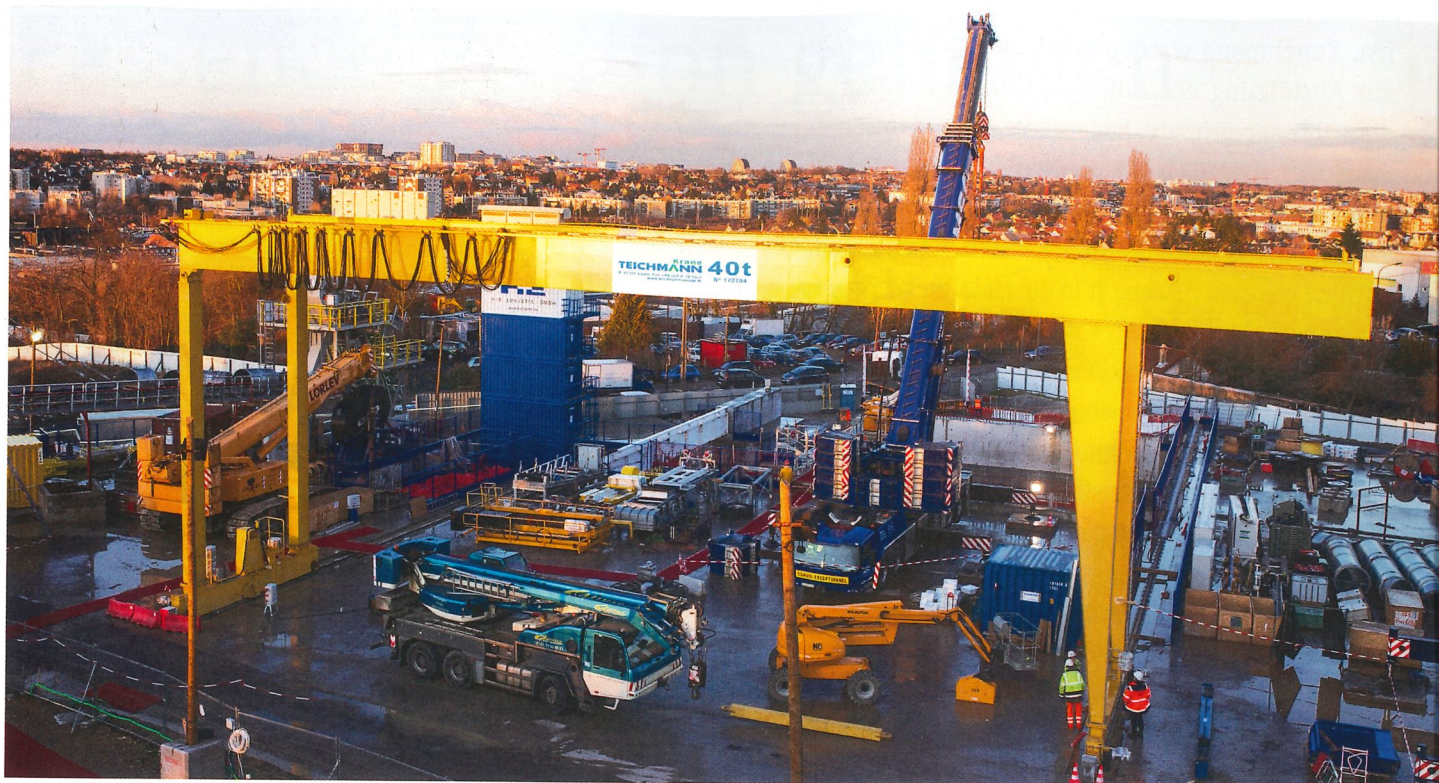
Kran Nr. 2: Ein generalüberholter Zweiträger-Portalkran in Kastenbauweise (40 t x 18,60 m + 2,50 m) wird auf seinen 80 m langen Fahrweg gestellt.
