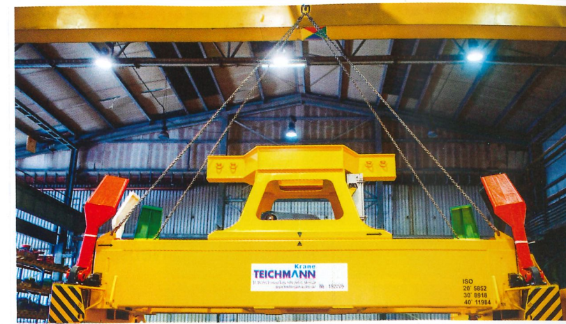
Die Generalüberholung vom 41-t-Spreader konnte Teichmann Krane in sechs Wochen abschließen.
